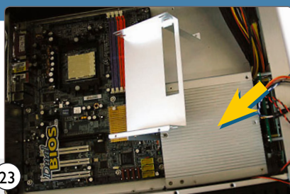
24 Hide the cables between the cage and the heatsink. Verlegen Sie die Kabel zwischen dem Käfig und der Kühlrippe.
