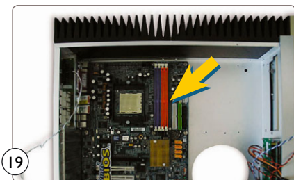
16 Change the rear panel mainboard cover with the original one of your mainboard. Wechseln Sie das Anschlusspanel gegen das originale Ihres Mainboards aus.
